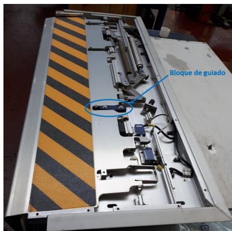
Figura 1. Ubicación del bloque de guiado de la rampa PMR.
